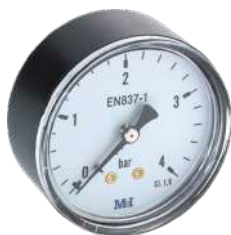
Manomètre sec horz. boîtier en acer noir, Cl.1,6
